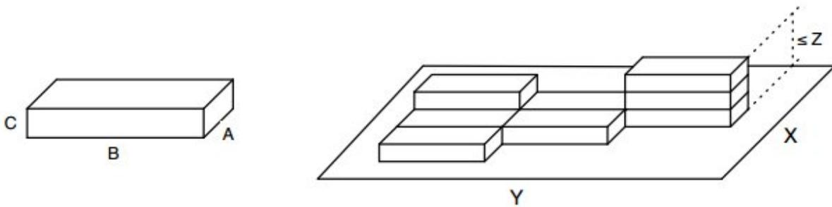
Devido a limitações do guindaste utilizado, os contêineres só podem ser carregados alinhados com o navio. Ou seja, os contêineres só podem ser colocados sobre o navio de tal forma que a largura e o comprimento do contêiner estejam paralelos à largura e ao comprimento do navio, respectivamente.
